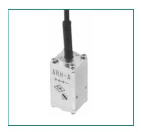
Die Aufnehmer der Baureihe ARH sind kompakte Sensoren zum Messen kleiner Beschleunigungen. Die Aufnehmer sind komplett wasserdicht und können für Messungen unter Wasser, im Boden, in Beton oder unter anderen widrigen Umgebungsbedingungen eing esetzt werden.
