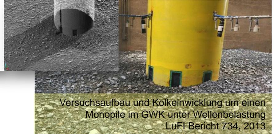
Versuchsaufbau und Kolkeinwicklung um einen
