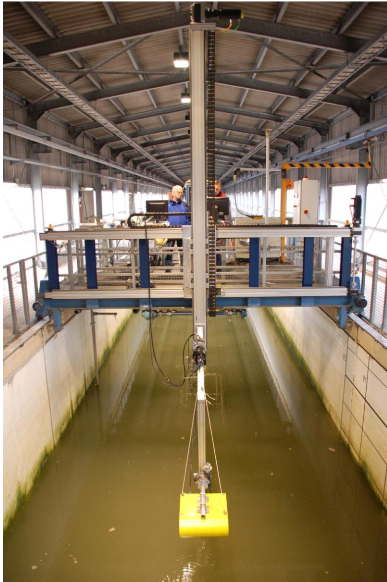
Messwagen fahrbar über dem Kanal mit Fächerecholot
