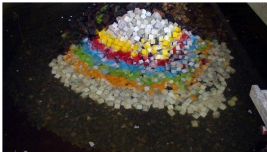
Abbildung: Wellenbrecherkopf mit ESG-Würfeln
