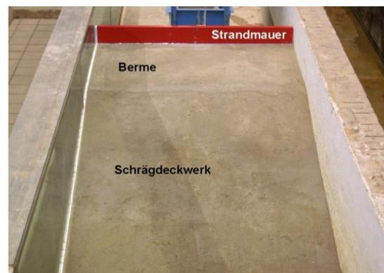
Abb. 5: Modellaufbau Regelprofil B
