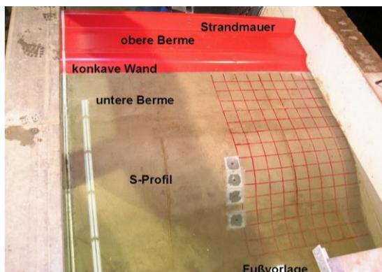
Abb. 4: Modellaufbau Regelprofil A
