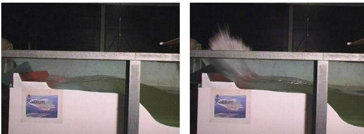
Abb. 7: „Springende“ Welle am Deckwerk im Regelprofil A während der Modellversuche
