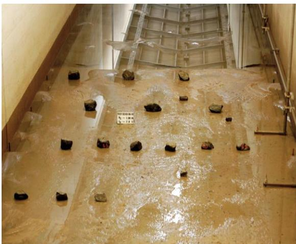
Abb. 1 Einzelsteine nach 150 Wellen mit  $H_{1/3} = 1,15$  m;  $T_p = 7,12$  s;  $d = 2,5$  m
