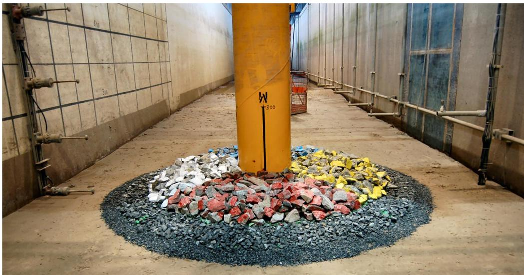
Abb. 7 Foto des Kolkschutzmodells im GWK
