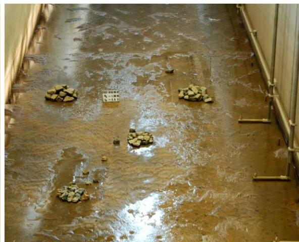
Abb. 2 Steingruppen nach 150 Wellen mit  $H_{1/3} = 0,96$  m;  $T_p = 5,36$  s;  $d = 2,5$  m
