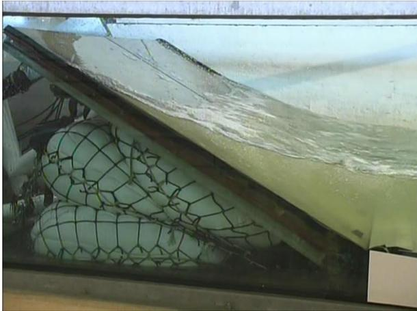
Abb. 1: Modell des mobilen Küstenhochwasserschutzbauwerks im Wellenkanal des LWI
