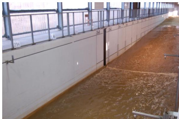
Abb. 10 Rückfluss des Auflaufwassers
