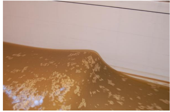
Abb. 6 Tsunami kurz vor dem Brechen
