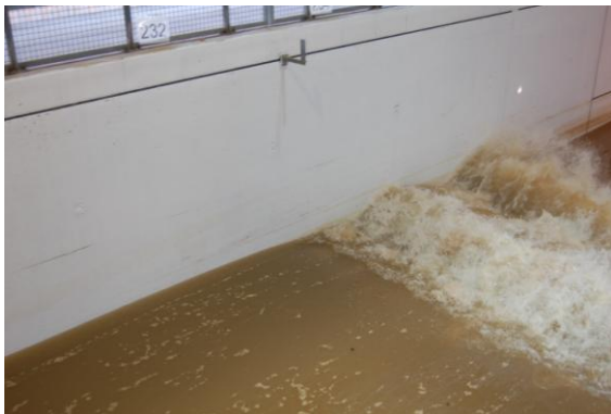
Abb. 7 Tsunami direkt nach dem Brechen
