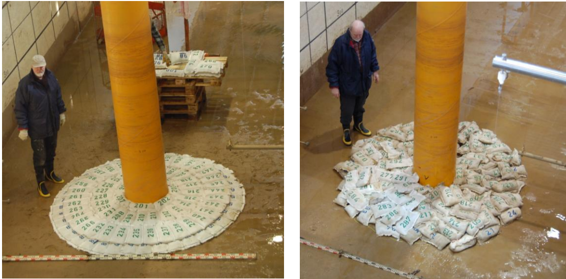
Abb.15 1:10 Modell von Kolkschutzvarianten mit Geotextilen Sandcontainern im GWK (links regelmäßige Verlegung, rechts unregelmäßige Verlegung)
