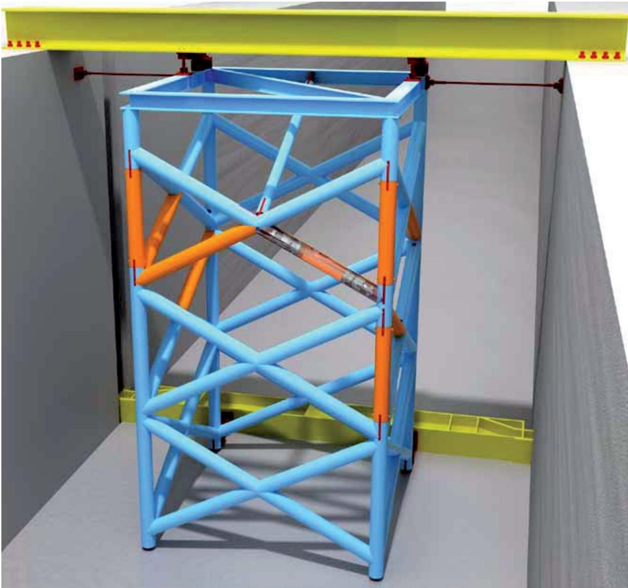
3D-CAD-Konstruktion, welche sehr genau konstruiert werden musste. Eine Fachwerksstabhälfte ist transparent dargestellt, um die Kraftmesszellen sichtbar zu machen
