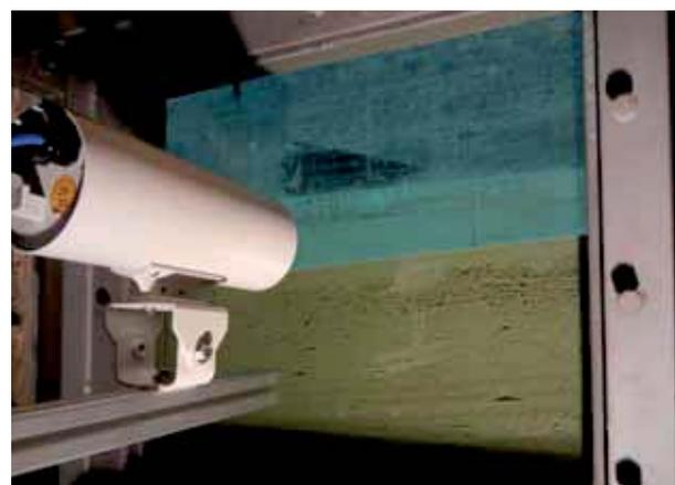
Beobachtung des Sedimenttransports mit einer Hochgeschwindigkeitskamera
