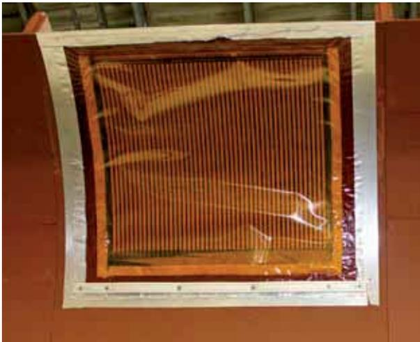
So wurde das Pressure Pad am Wellenabweiser befestigt
