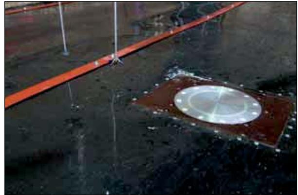
Direkte Messung der Bodenschubspannung
