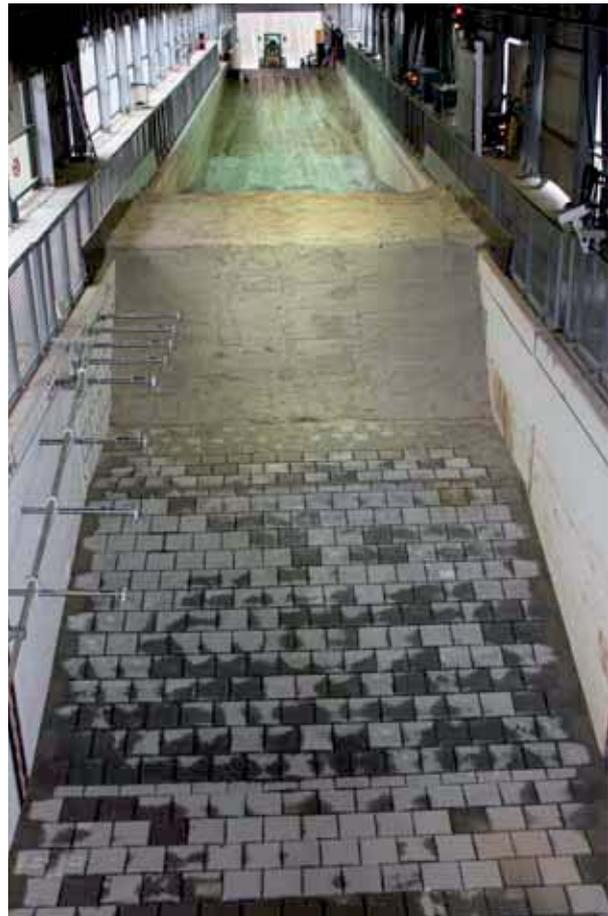
Modellaufbau mit Deckwerk und Düne im GWK
