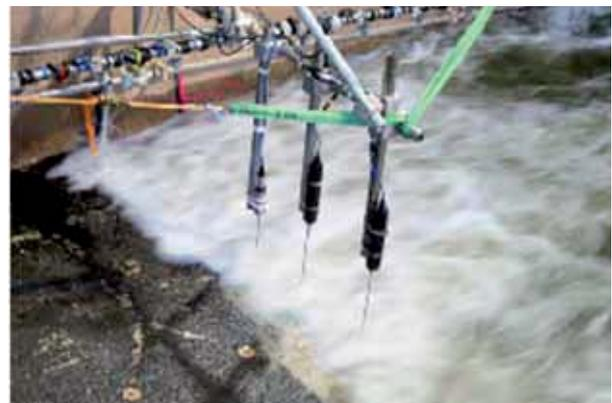
Messung von Geschwindigkeitsprofilen in der Grenzschicht
