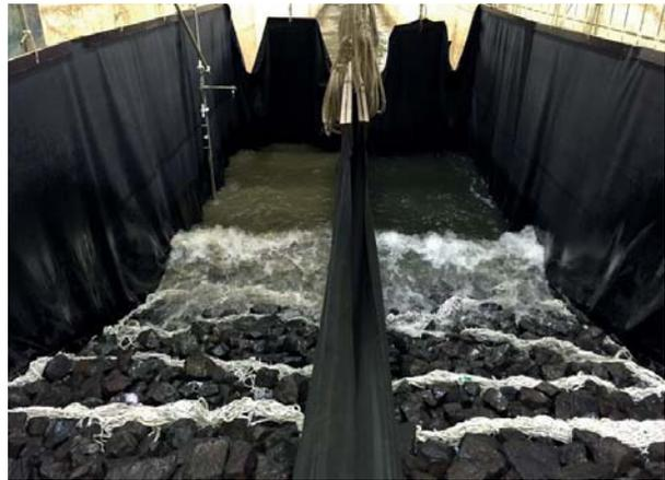
Brechende Wellen in den beiden Versuchskammern
