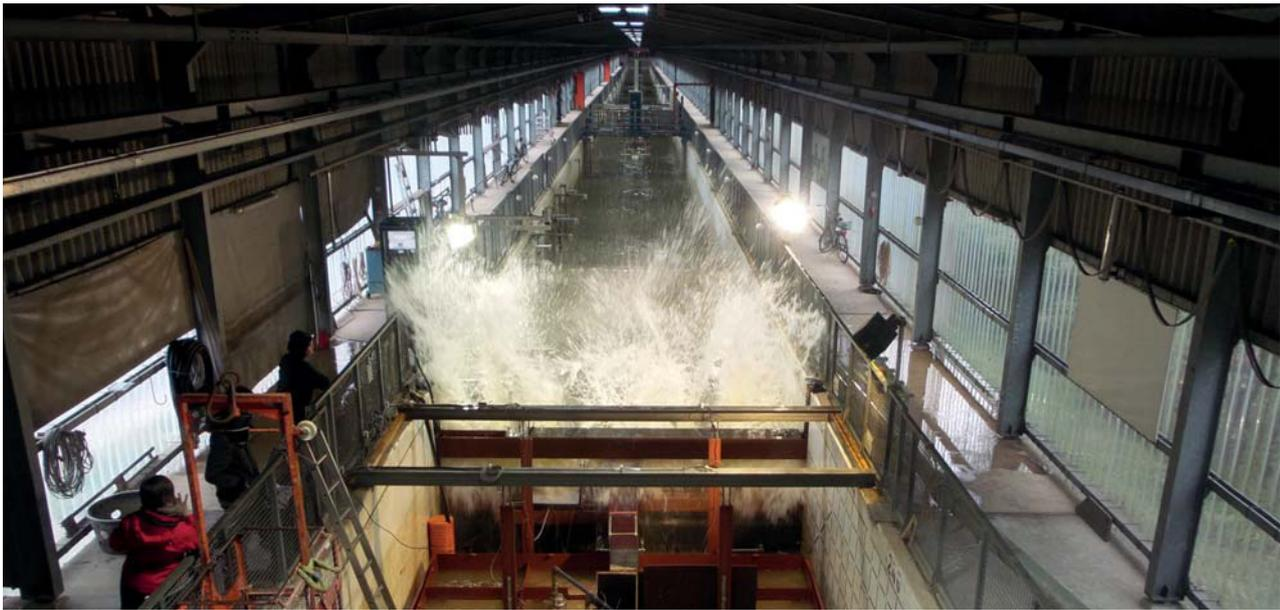
Brechende Welle an der Hochwasserschutzwand
