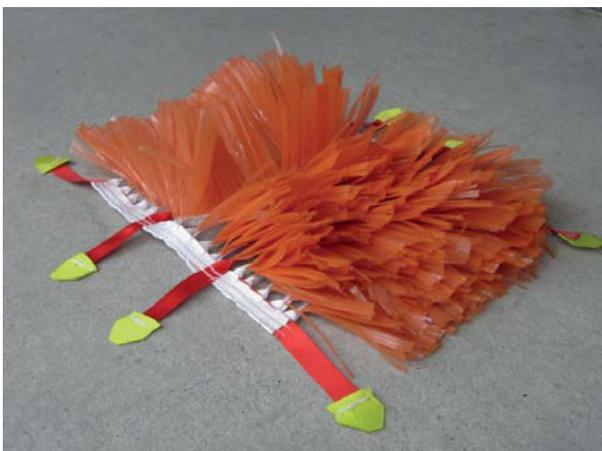
Ein verkleinertes Modell einer Kolkschutzmatte der Firma Seabed Scour Control Systems Ltd (SSCS). Diese sogenannten „Frond mats“ wurden ursprünglich natürlichem Seegras nachempfunden und sollen in Vorversuchen am GWK zum Einsatz kommen.
