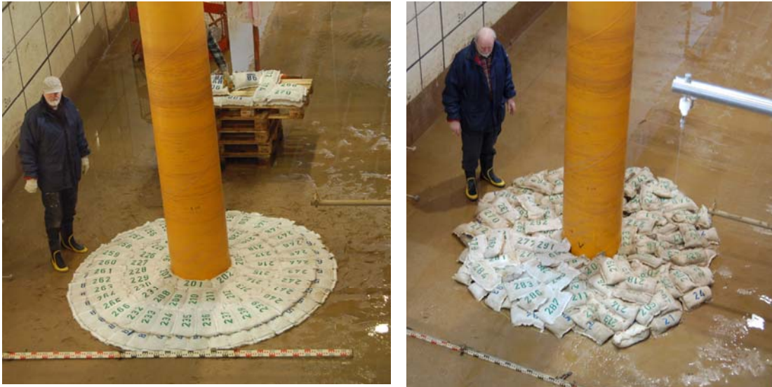
Abb. 10 1:10 Modell von Kolkschutzvarianten mit Geotextilen Sandcontainern im GWK (links regelmäßige Verlegung, rechts unregelmäßige Verlegung)
