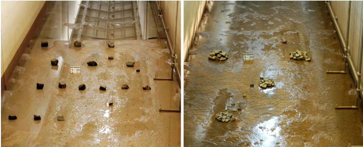
Abb. 3 Anordnung der Schüttsteine im GWK (links die 18 Einzelsteine, rechts die 4 Steingruppen, jeweils nach einem Versuch mit einzelnen Steinverlagerungen)
