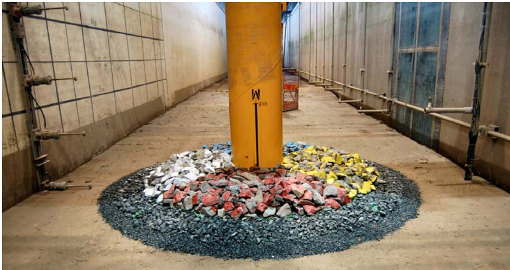
Abb. 13 Foto des eingebauten Kolk schutzes mit Schüttsteinen im GWK
