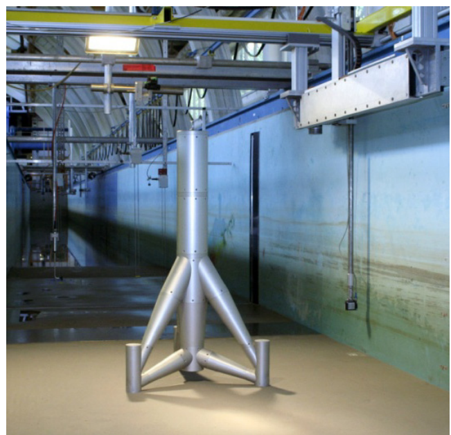
Abb. 2: Modellbau im Wellenkanal zur Kolk- und Strömungsuntersuchung, Maßstab 1:40
