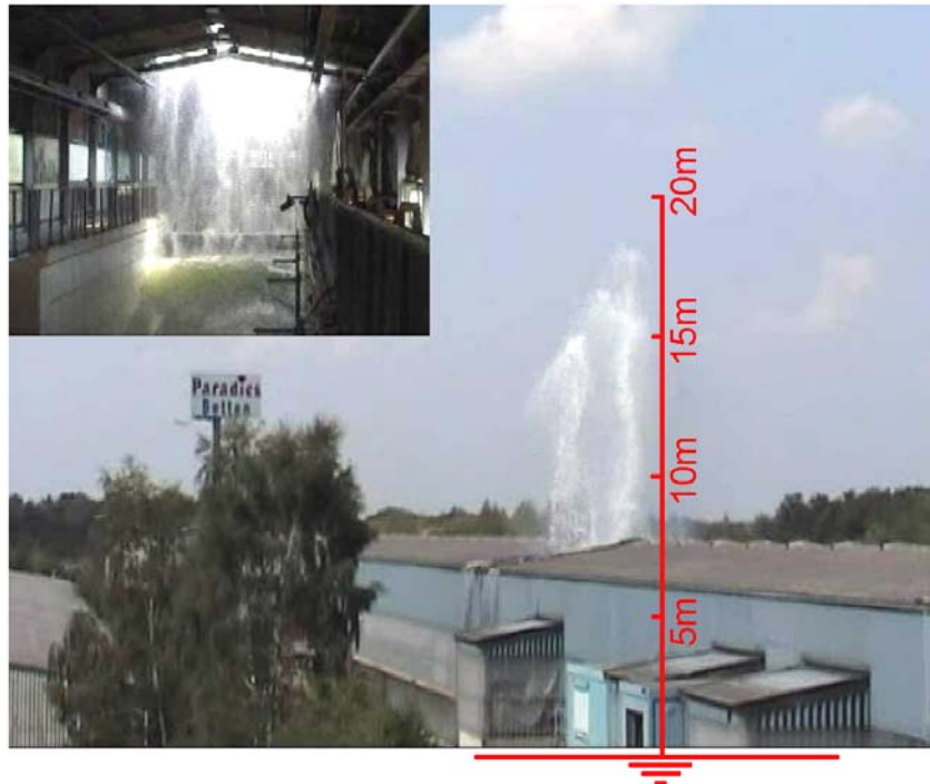
Abb.7: Wellenwirkung einer brechenden Welle am senkrechten Wellenbrecher
