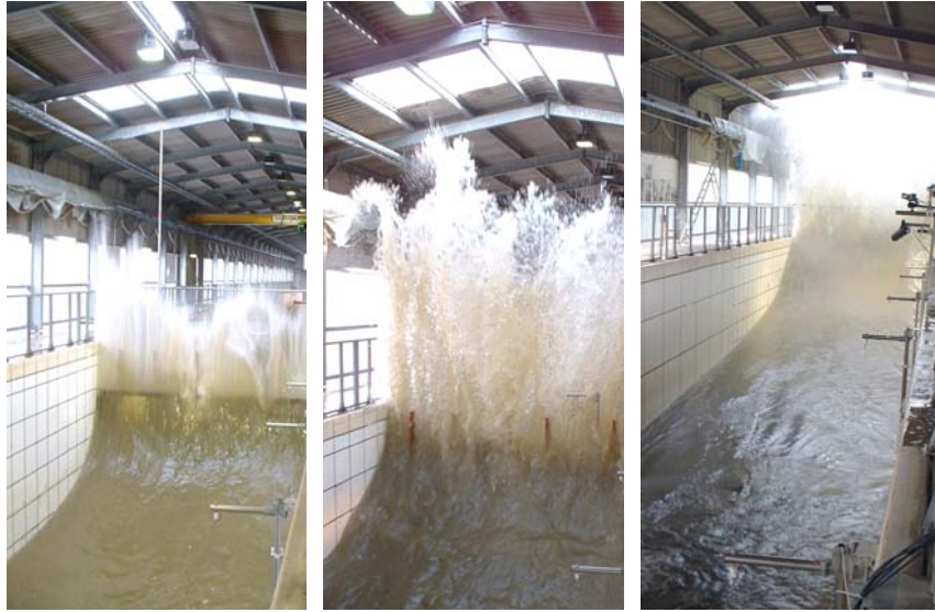
Abb. 6: Wellenwirkung am vertikalen Wellenbrecher infolge brechender Wellen
