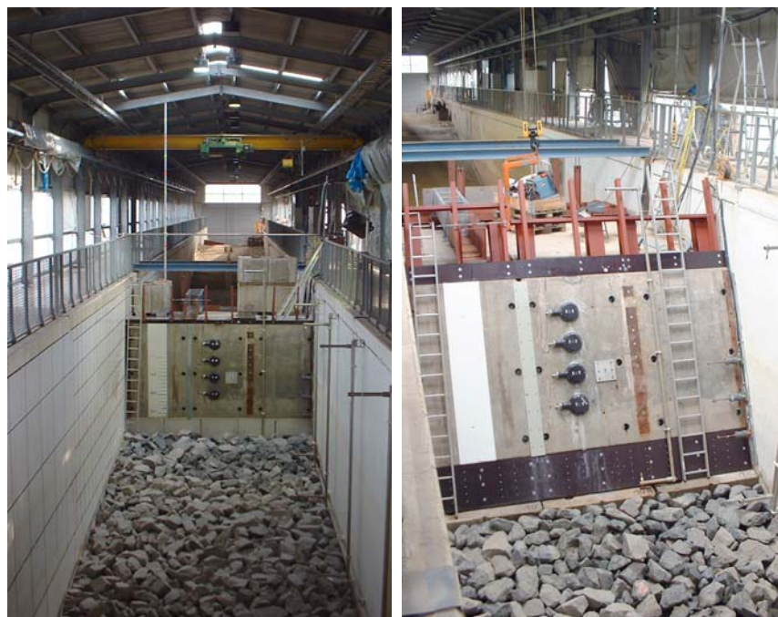
Abb. 2: Wellenbrecher mit vertikaler Wand (links) und geneigter Wand (rechts)
