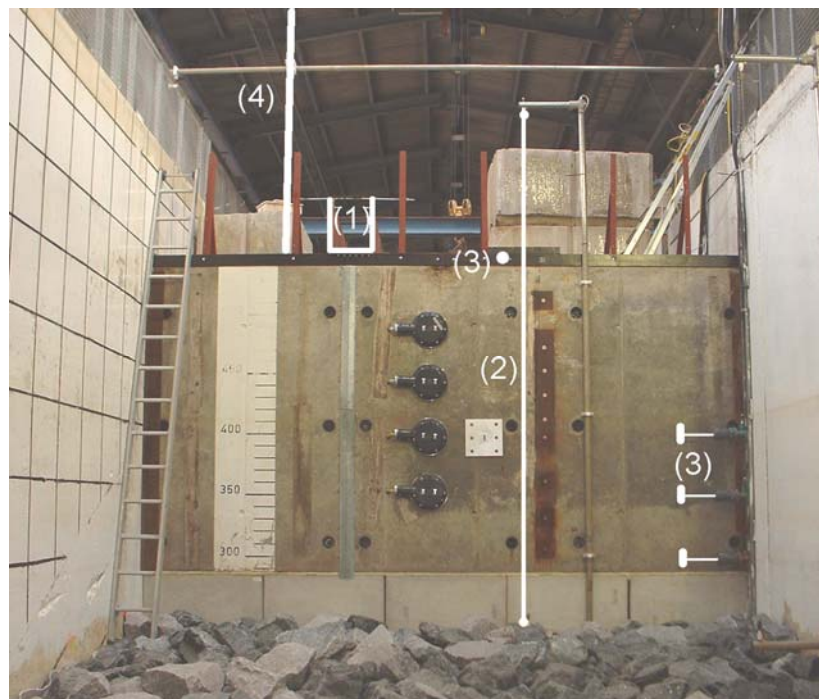
Abb. 3: Messeinrichtungen: Zulaufrinne (1), Wellenpegel direkt an der vorderen Wand (2), Geschwindigkeits-Sensoren (3) und Pegel für die Erfassung des Überlaufstrahls mit digitaler Videokamera (4)
